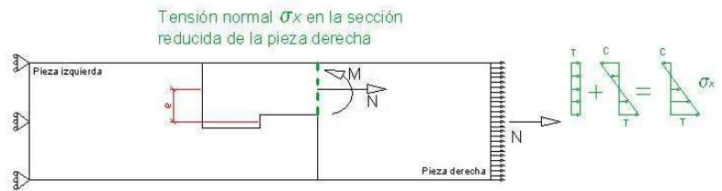
Fig. 7. Tensión normal \sigma_x en la sección reducida de la pieza.
